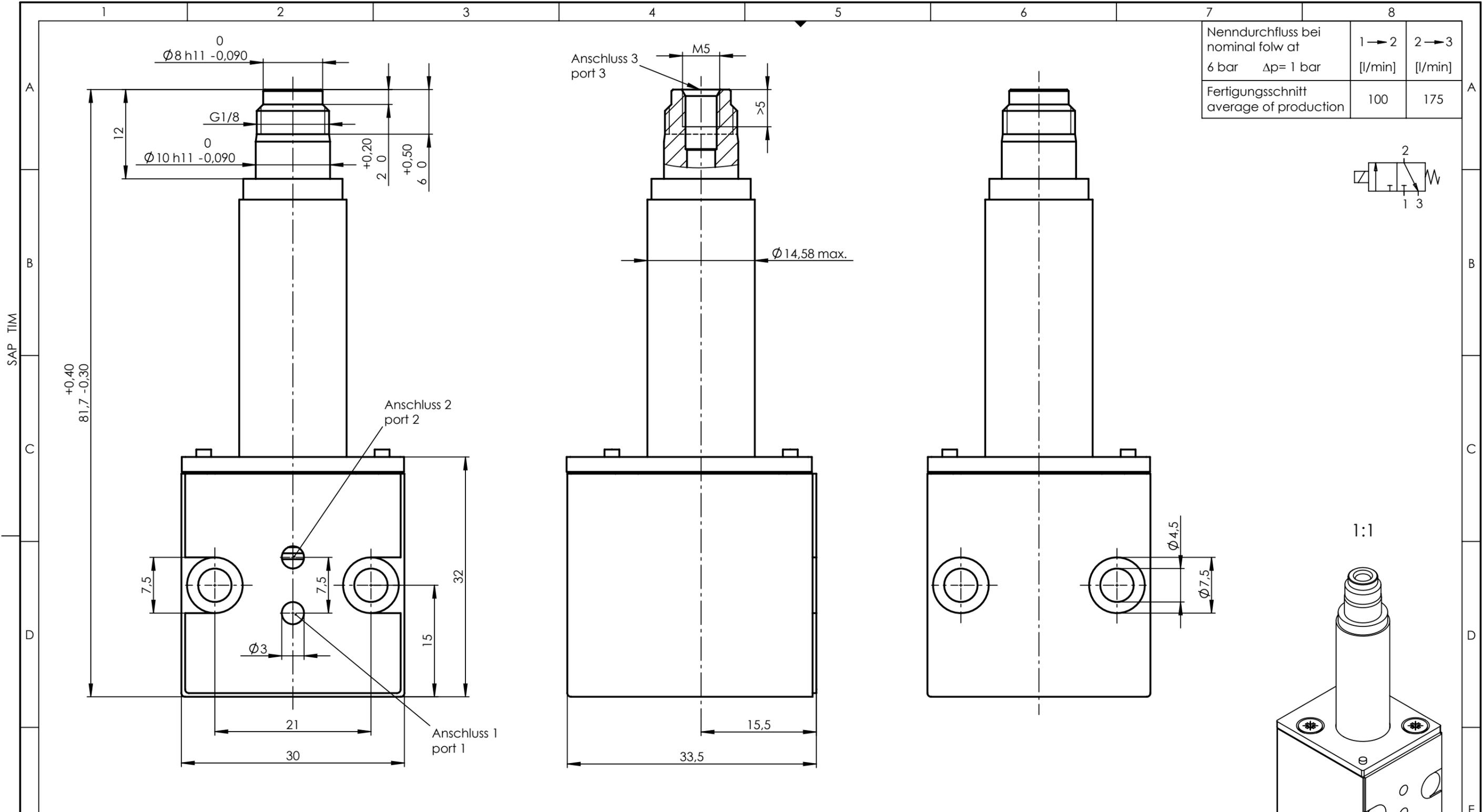
Belüftungsnennweite 2,0 mm
