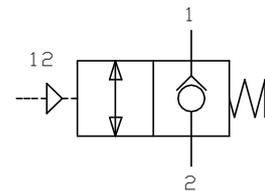
Ventil kann auch mit Anschluß 2=Druckanschluß, Anschluß 1=Arbeitsanschluß betrieben werden
